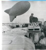
Запуск аэростата наблюдения (звизу привязана gondola, в которой уже находится экипаж). Ленинградский фронт.
